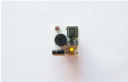
555타이머, 스위치, 저항, 배터리 클립, 스피커, 컨덴서, LED, 칩소켓을 다 부착한다. Install the 555 timer, switch, resistance, battery clip, speaker, condenser, LED and chip socket.
